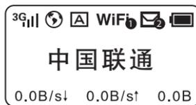
注: 如果不进行任何按键操作, 屏幕高亮45秒后低亮, 低亮10秒后熄灭。如果有按电源开关操作, 屏幕变成高亮, 显示相关内容。
