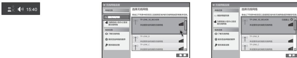
注: 此无线数据终端的默认 SSID (无线网络名称) 为 TP-LINK\_3G\_xxxxxx (xxxxxx 代表无线数据终端的 MAC 地址后 6 位, MAC 地址可在设备背面的标贴上查看)。此无线数据终端默认未开启无线加密, 为保护您的无线网络安全, 强烈推荐您在“4 设置无线数据终端”中设置加密。
